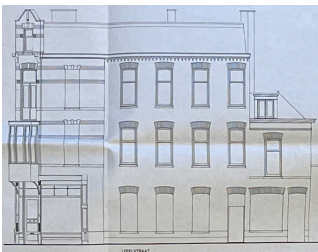
Tekening van de gevel aan de Lepelstraat, links de bestaande, en rechts de nieuwe toestand.
