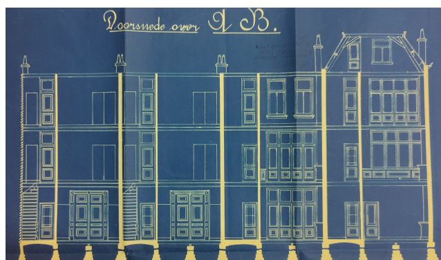
Uitsneden van het "Plan en ontwerp van drie huizen en een winkelhuis aan de Beeklaan te 's Gravenhage." Links de begane grond en rechts doorsnede over de vier panden. Het diepere en hogere, rechter pand onder schilddak betreft Beeklaan 341.
