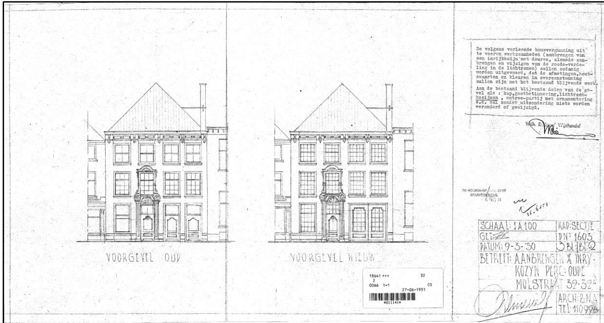
Vergunningaanvraag voor verbouw van de voorgevel van het pand Oude Molstraat 30-32 volgens variant A van 9 maart 1950, tekening van de architect C. Reinerie (Gemeente Den Haag, bouwarchief, vergunning 27 juni 1951). Toegevoegd is een verklaring van de eigenaar, W. Richters. De maatvoering van het nieuwe deurkozijn zal worden afgestemd op de maatvoering van de vensters, terwijl de rest van de gevel behouden zal blijven.
