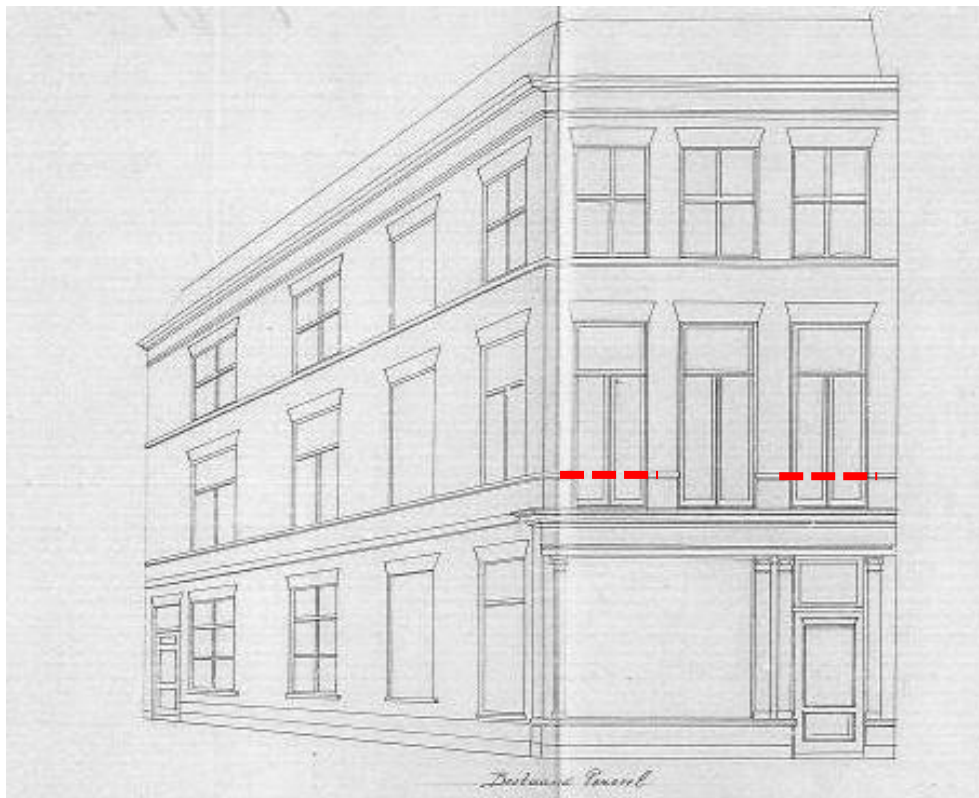
Afb.C12 Bouwtekening gedateerd 20-12-1897 met optekening destijds van de bestaande toestand ter voorbereiding van een verbouwingsplan voor een nieuwe winkelpui. Zoals al geconstateerd klopt de afgebeelde toestand op het reclameplaatje van afb.C11 niet met de werkelijk gerealiseerde toestand in 1886. De gevelindeling van de eerste en tweede verdieping komt nog steeds overeen met de huidige toestand. Ook de entree geheel links van de bovenwoning is in gewijzigde vorm nog steeds zichtbaar. De buitenste vensters in de voorgevel lopen tegenwoordig niet meer naar vloerniveau door. [ bouwarchief gemeente Den Haag
